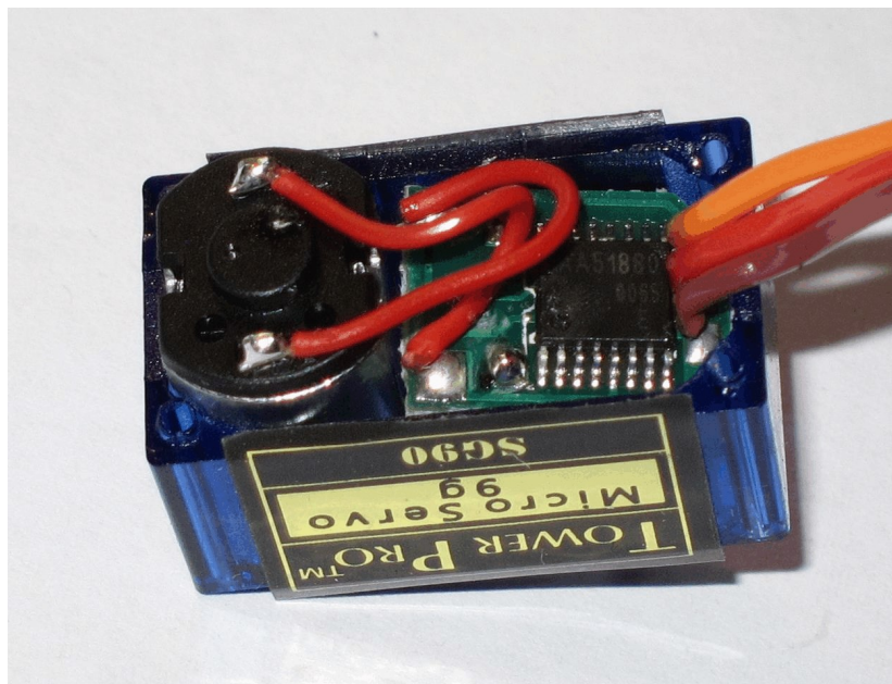
Motor links, Vergleichler und Stromsteuerung rechts
